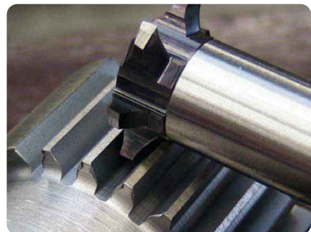
Gear finish mill module 2; z = 23 Fraise de forme module 2; z = 23
