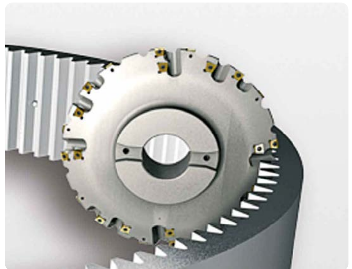
Roughing of annulus module 16 Ébauche denture intérieure module 16
